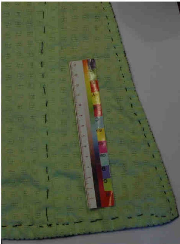
obr.22 obraňovací a zpevňovací šev hran oděvu - vložení předního klínu obr. 23 švy kápě - vložení klínky - zevnitř
